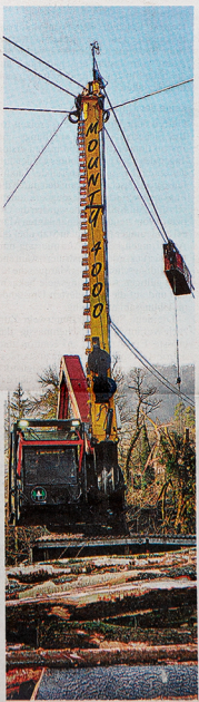
Der Mounty 4000 ist Seilkran und Vollerter in einem. Die Laufkatze, die «Seilbahn» kommt soeben mit Astmaterial an.
